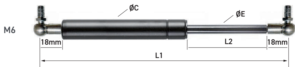
Amortecedor M6 | Haste Ø8 | Corpo (C) Ø18
